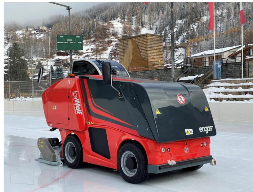
*Die neue elektrische Eisbearbeitungsmaschine «Engo» im Einsatz*
