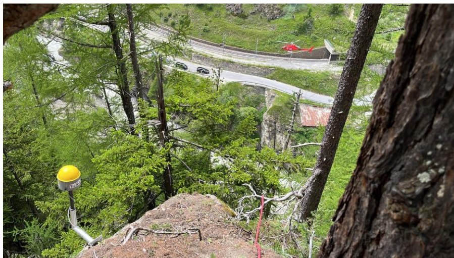
Satellitengestützte Überwachung der Rutschung
