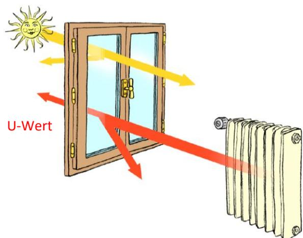
Wärme hat die Eigenschaft, immer vom wärmsten Ort zum kältesten zu fließen. Der U-Wert zeigt an, wie stark die Verglasung die Wärme durchtreten lässt.
