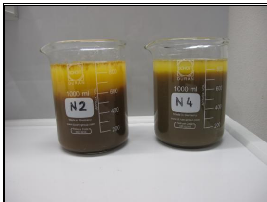
Abgesetzte Belebtschlammprobe: Deutliche Gelbfärbung des Überstandes (Gelbschlamm)
